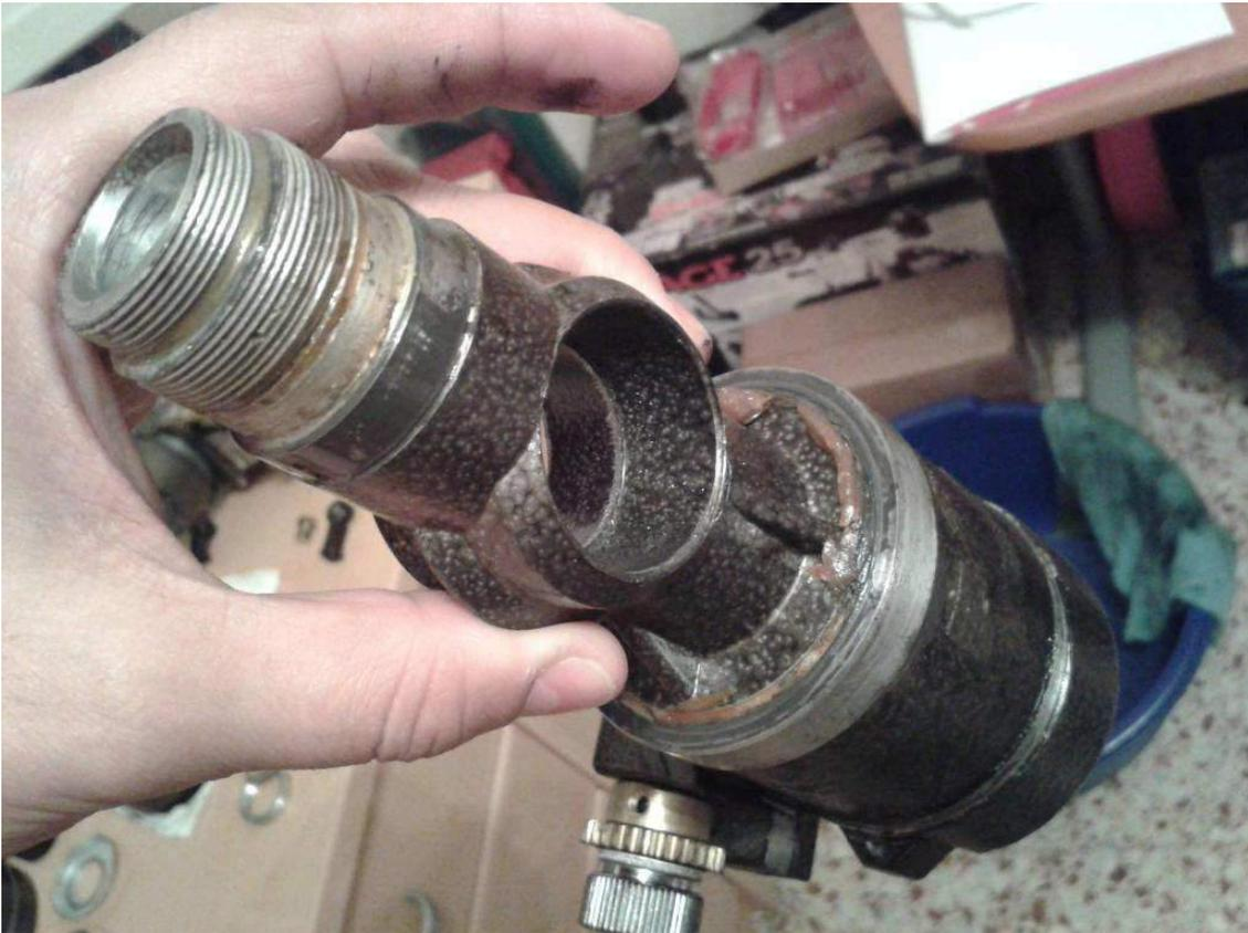
Y sacar la corona dentada de la carcasa del eje DEC
