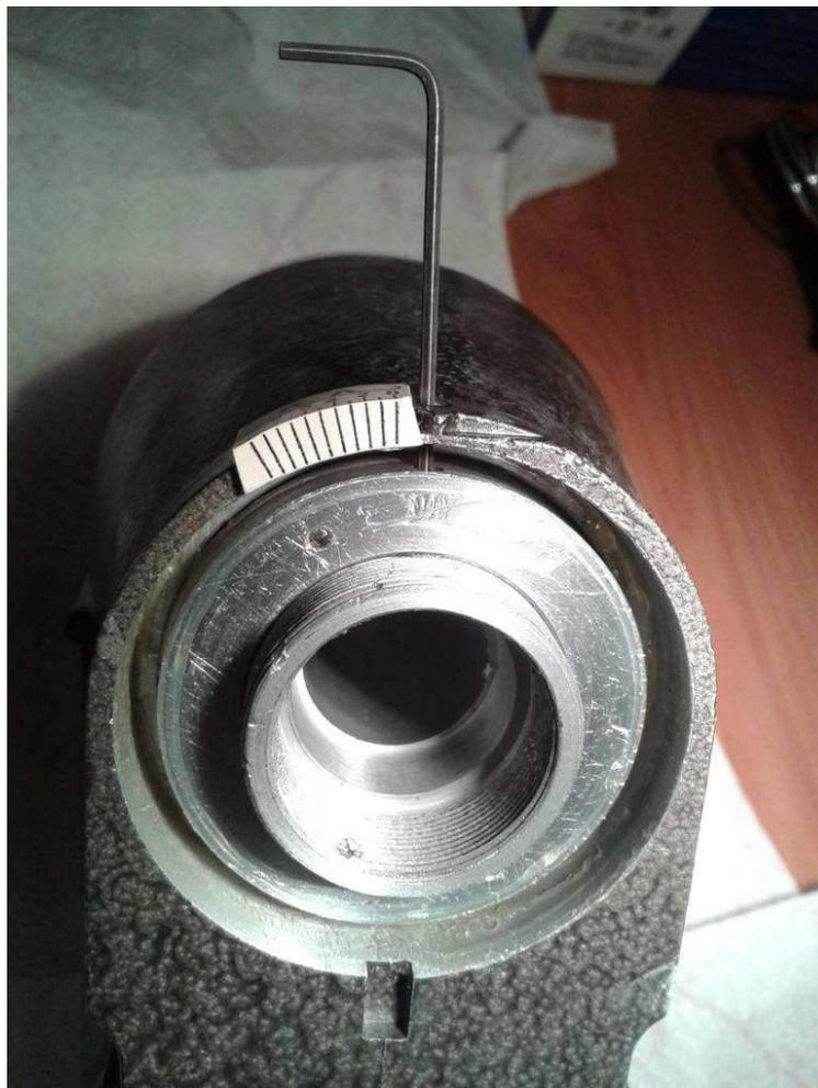
Estos tornillos allen “muerden” la rosca del eje AR y crean rebaba, que puede dificultar la extracción y el montaje de la rosca de fijación, pero también pueden hacer que esta se mueva un poco al apretarla, por lo que deberemos comprobar la resistencia y la holgura del eje tras apretarlos todos y volver a aflojarlos y ajustar si fuese necesario.
