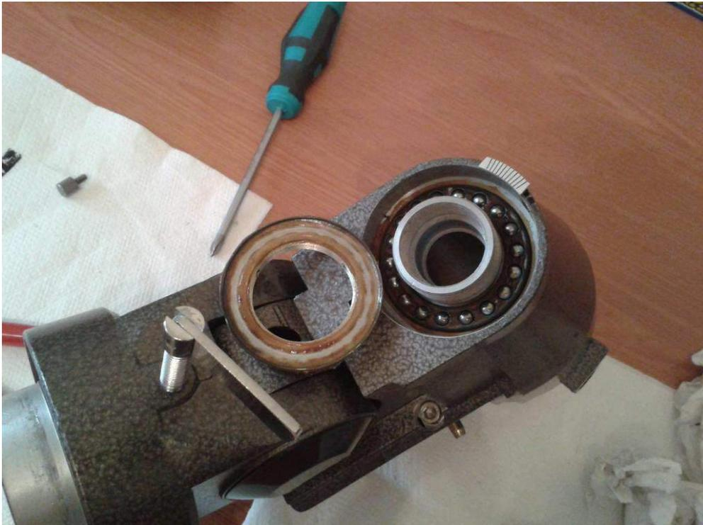
Ya podemos sacar el eje AR de su carcasa y la corona dentada. Esta tiene una arandela transparente en su base y otra superior (no intercambiarlas) La corona debería salir sin problemas, de todas formas mejor seguir los cuidados descritos para la corona del eje DEC en su extracción. Esta me dio menos guerra, pero se me trabó un par de veces. Ahora podemos sacar la zapata del embrague si no nos ha salido antes.
