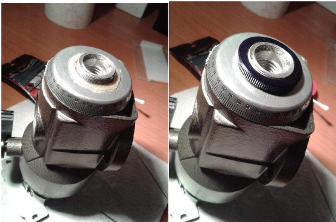
Le damos la vuelta al eje y atornillamos el soporte del telescopio con sus dos allen.
