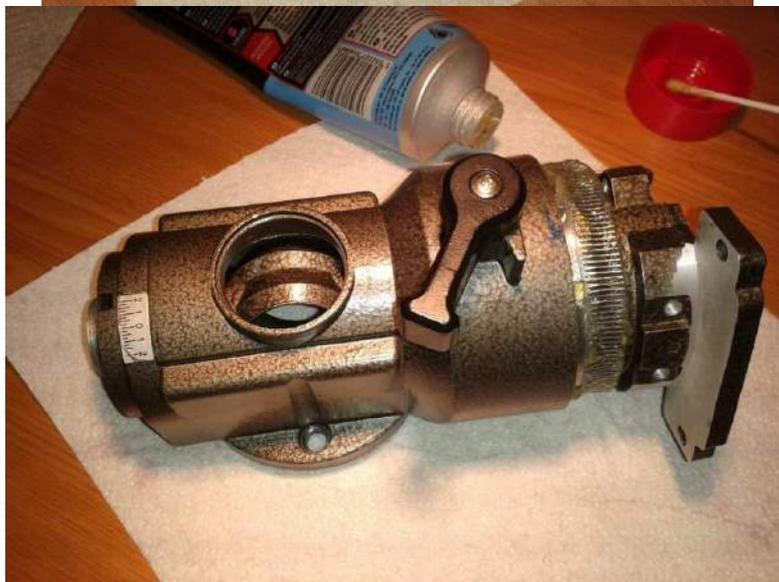
Le damos la vuelta al eje para montar la rosca que fija el eje DEC.
