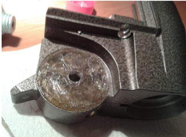
Deslizamos la carcasa del eje AR en la base con cuidado de que no se salgan las arandelas de su sitio y ponemos el tornillo pasante. Engrasamos la base de las arandelas del tornillo (no las arandelas) Si se ha manchado de grasa la rosca del tornillo la limpiamos y ponemos la arandela, la tuerca y la apretamos bien fuerte. Si montamos antes los tornillos delantero y trasero de latitud y los fijamos nos ayudarán a que no se mueva la montura al apretar.
